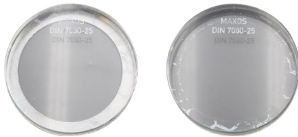
Bild 4: (links) Schauglasplatte inkl. verpresster novaphit® MST-Dichtung mit XP-Technologie, (rechts) Schauglasplatte mit minimalen Rückständen von der entfernten novaphit® MST-Dichtung
