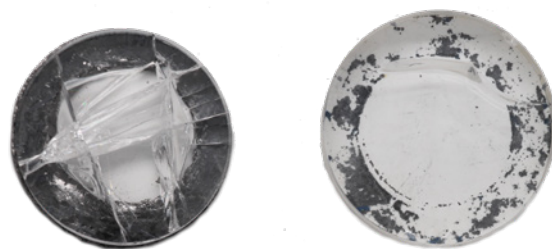
Bild 3: Beschädigte Glasplatten mit Standard Graphitdichtung
