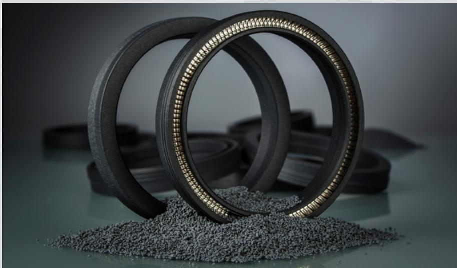
Der Hallite Multispring Optiseal® setzt neue Maßstäbe in der Dichtungsindustrie. Entwickelt als moderne Alternative zu traditionellen Dachform-Dichtsätzen und Stopfbuchspackungen, kombiniert dieses Produkt mehrere Dichtkanten in einem einteiligen Element, jeweils mit einer eigenen Feder vorgespannt. Damit eliminiert es den Bedarf an axial eingebrachter mechanischer Vorspannung und reduziert den Serviceaufwand erheblich.
